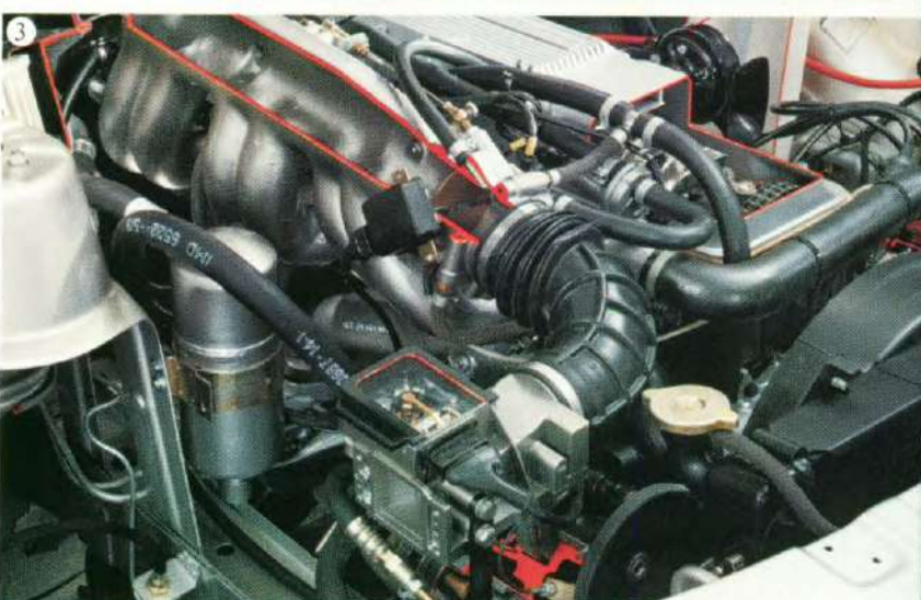
① Wigvormige verbrandingskamer Motortrillingsdempers ② Hydraulische klepstoters 3.0 E motor ③ 3.0 E motor
